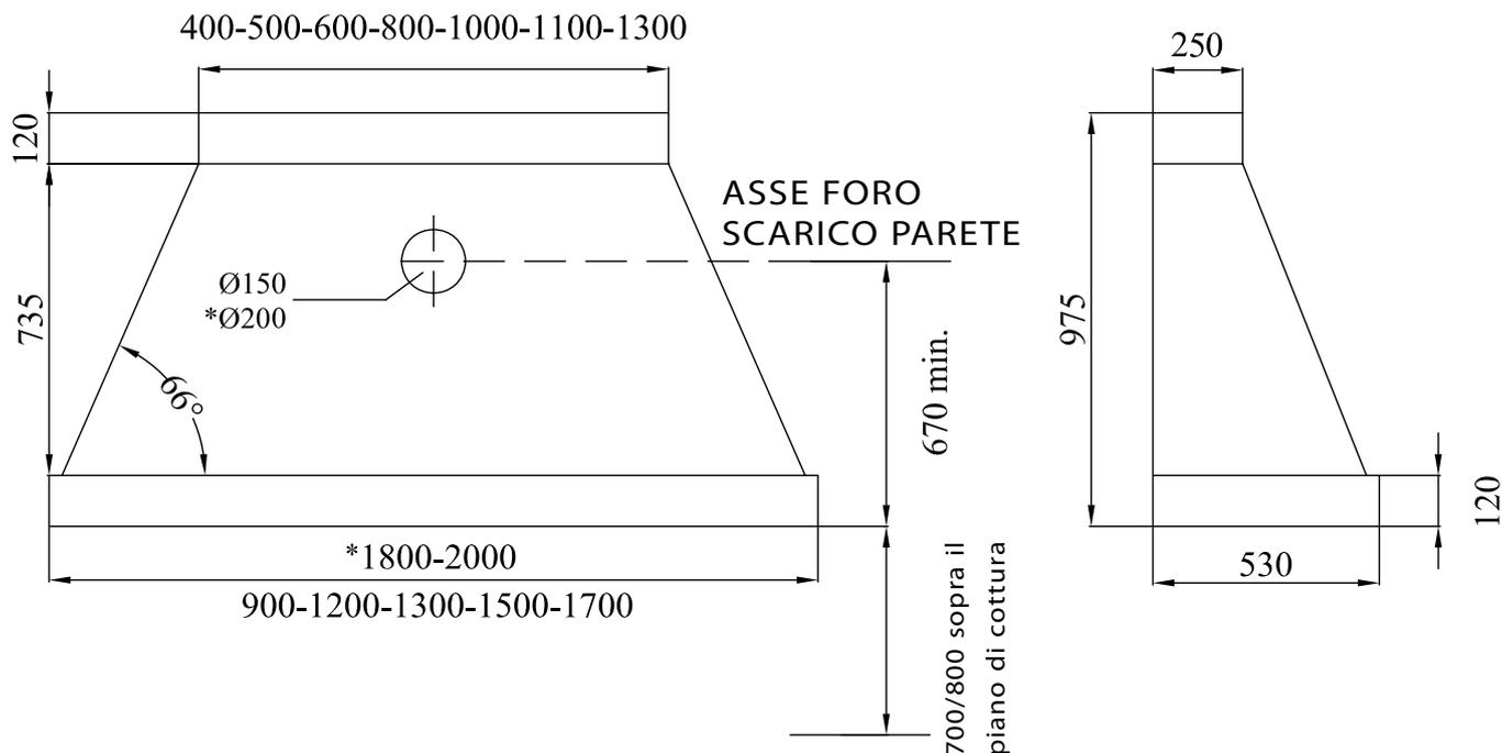
Non collegare la cappa ad uno scarico ridotto rispetto a quello previsto. Rischio di malfunzionamento e surriscaldamento del motore. Nel caso non fosse possibile predisporre lo scarico  $\varnothing$  200 mm (1200 mc/h), ove previsto come standard (K180-200), si consiglia di richiedere la cappa con motore per scarico  $\varnothing$  150 mm (900 mc/h).
